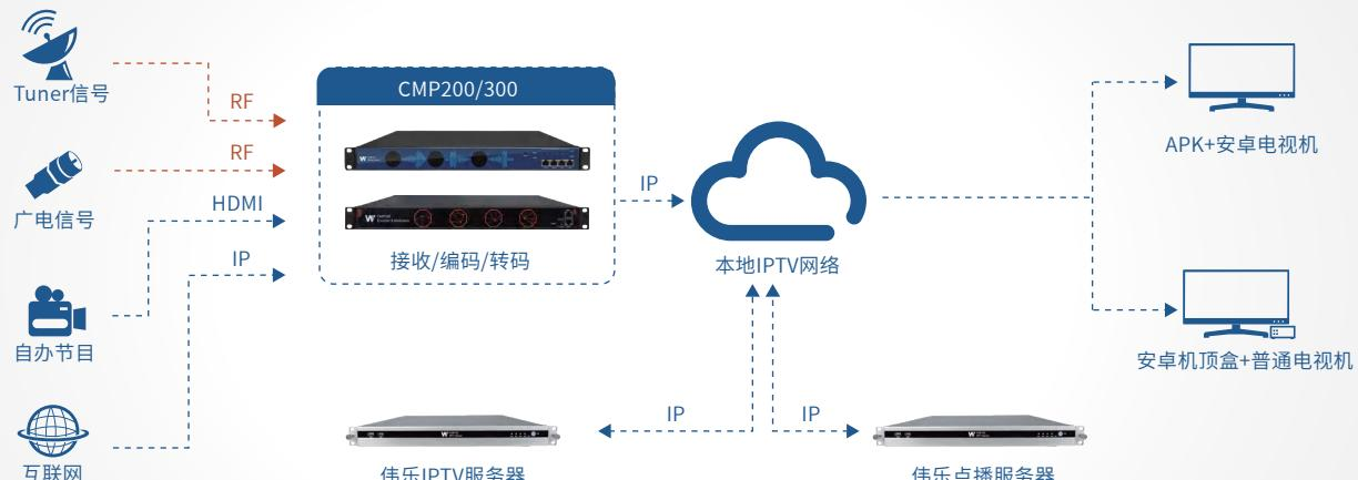
该方案以伟乐IPTV服务器作为内容分发和管理核心，使用伟乐CMP产品进行前端信号（如tuner、有线、地面或机顶盒、DVD等）接收和处理，再配以伟乐定制终端，具有较高的集成度和良好的兼容性，同时也大大地简化了技术维护过程。
