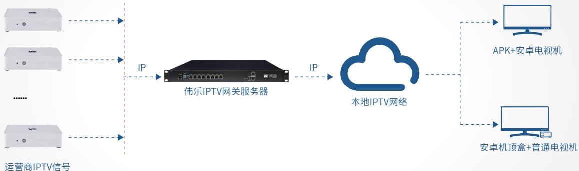
该方案中，伟乐IPTV服务器直接接收运营商的IPTV信号，并进行管理和分发，具有操作简易，维护便捷的特点。该方案主要适用于具备本地电信、联通或移动IPTV信号接入条件的酒店，单台设备即可完成信源接收处理及分发。
