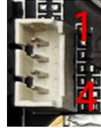
● eDP LCD 接口 (eDP LCD JACK) 座子间距 2.0MM
