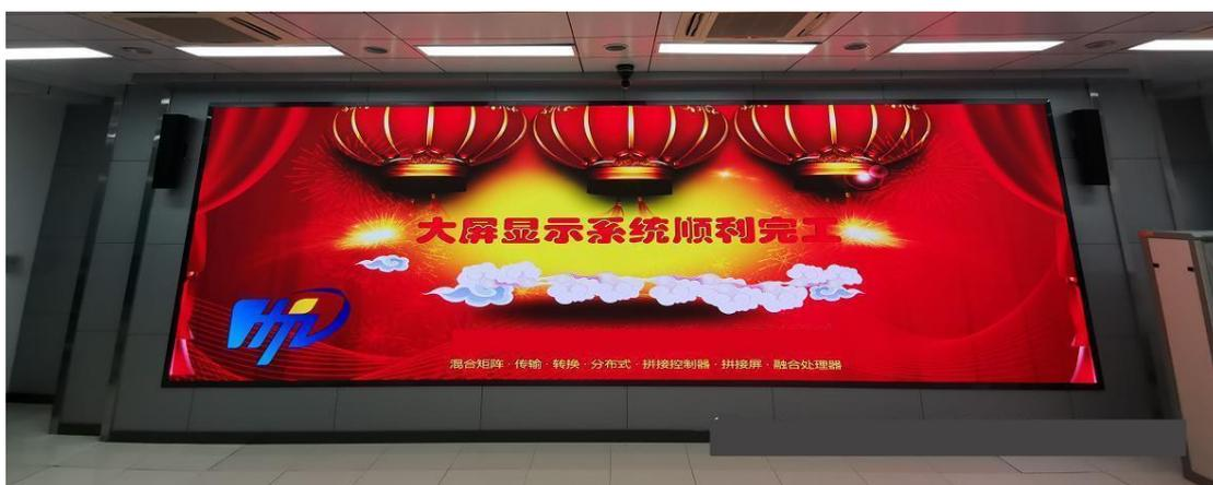
小间距 HTD 系列小间距显示屏采用像素级的点控技术，实现对显示屏像素单位的亮度、色彩的还原性和统一性的状态管控。在显示屏的生产过程中全部采用了自动回流焊接工艺，无需手工后焊。高刷新、高灰阶：刷新率可达3840HZ 以上，灰度 16Bit 以上，显示画面细腻真实，亮度稳定均匀，无闪烁，无颗粒感。
