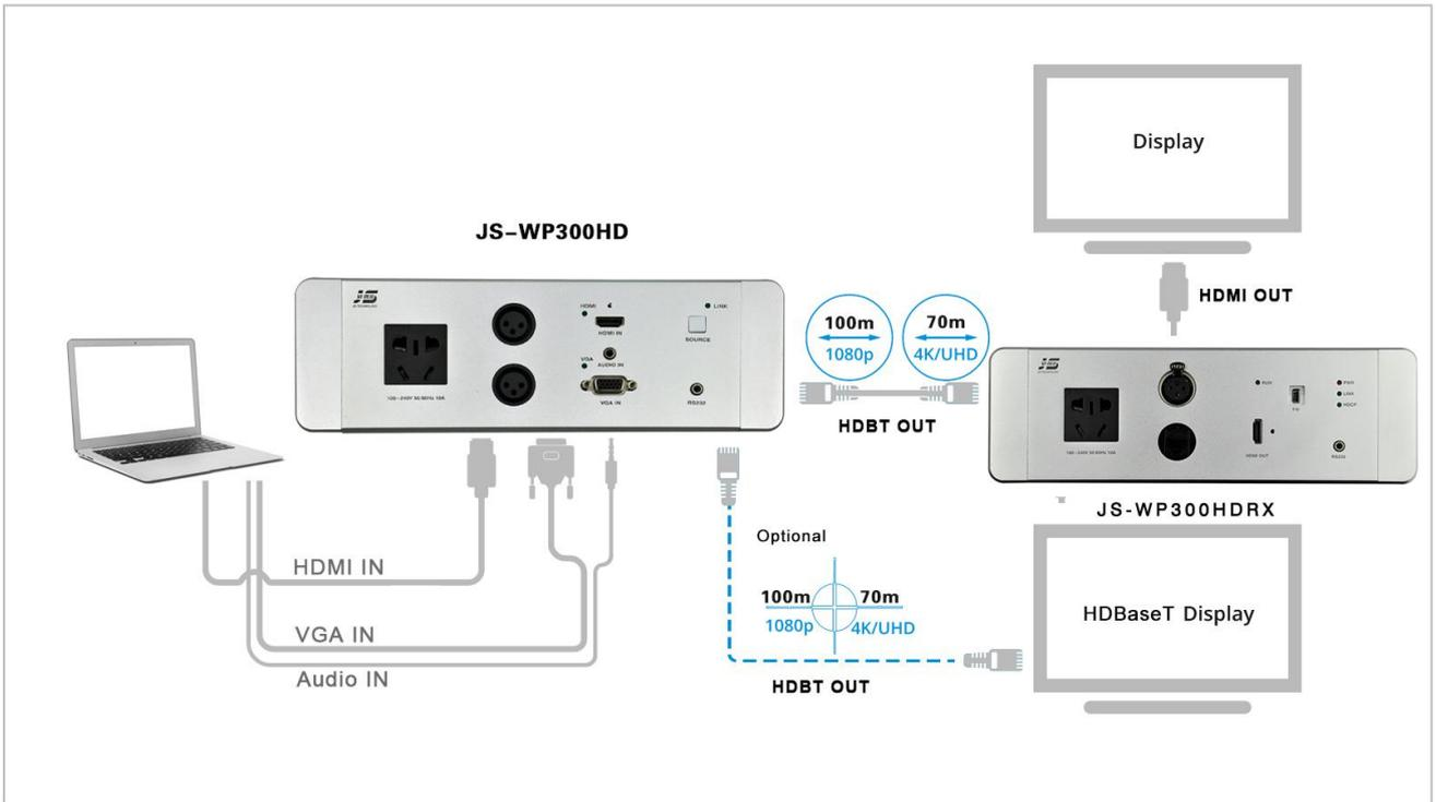
某烟草集团选用金视墙面型、地面型远距离传输插座 JS-DC170HD、JS-WP300HD、JS-WP300HDRX，实现从地面及墙面连接信号传输 4K 图像到显示设备，信号能选择 VGA/HDMI 两种不同的信号通过 JS-DC170HD/JS-300HD 来实现远距离传输，传输介质选用 CAT6 类网线，能够实现 1080P 信号 70 米距离传输，4K 信号 40 米（且支持 POC 单边双向供电）/JS-300HD 能够实现 1080P 信号 100 米距离传输，4K 信号 70 米距离传输！
