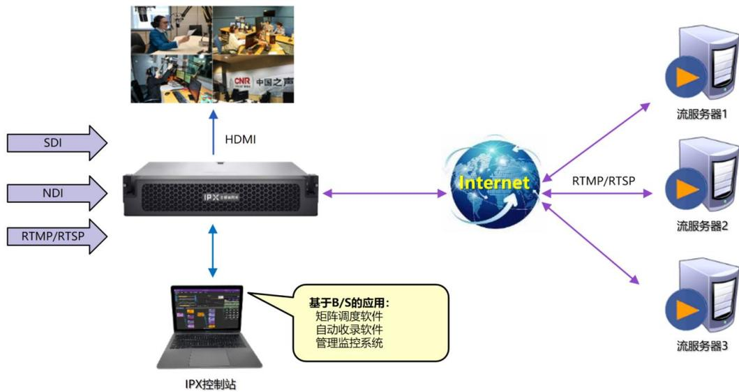
安徽励图信息科技股份有限公司“流媒体矩阵调度系统”基于 Linux 架构，产品能够实现 SDI、SMPTE 2110、SRT、NDI、RTSP/RTMP、UDP/RTP、本地文件、手机直播/移动通信背包直播等信号的多通道推拉流工作，支持节目单自动调度和背景音频的加解嵌，适用于多通道编单推拉流、无人值守慢直播、流媒体矩阵调度等多种应用场景。
